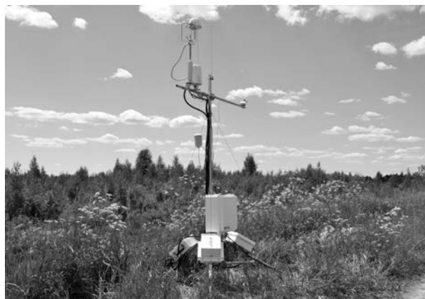
Рис. 1. Измерительный комплекс, установленный на обочине насыпной дороги, разделяющей два различных по увлажнению и растительности участка вторично обводненного осушенного торфяника; вид на «южный» участок
